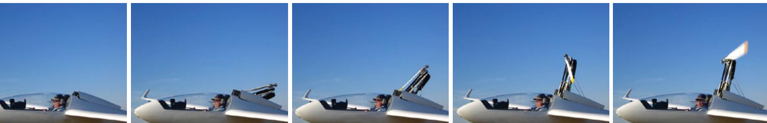
En seulement 14 secondes on extrait le moteur prêt au démarrage
