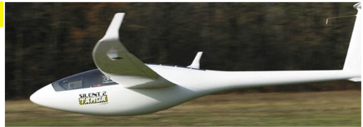
Das Ausfahren des Antriebes benötigt nur 14 Sekunden, der Motor lässt sich anschließend sofort starten.
